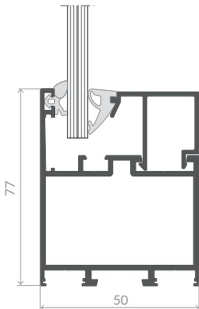
**ACS 50** ACS 50 sezione telaio Fisso
