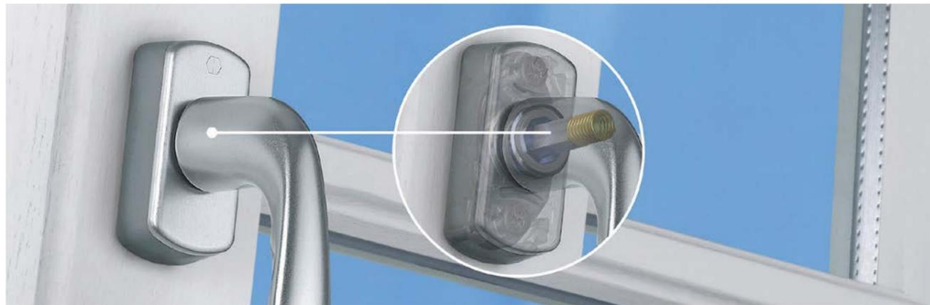
La poignée de fenêtre **Hamburg SecuForte®** adapte la longueur de la tige à la profondeur du profilé de la fenêtre. Ceci est rendu possible par un ressort de pression qui se trouve au milieu de la poignée sur la tige. Grâce au mécanisme à ressort, la tige est enfoncée en continu, ce qui garantit un positionnement correct.
