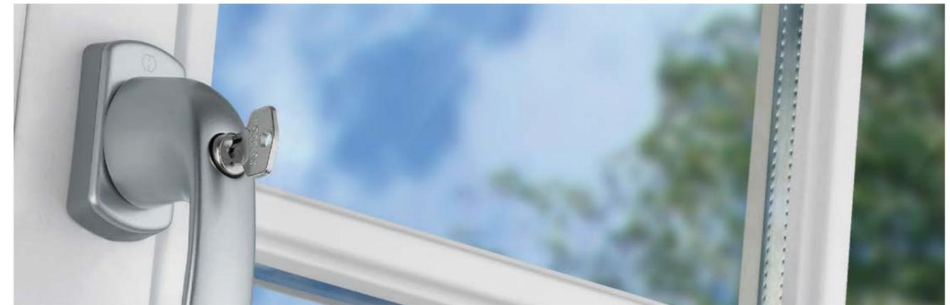
Dans le cas de la poignée **Toulon SecuForte®** à double fonction, la rotation n'est possible que lorsque le cylindre de fermeture à bouton est déverrouillé et enfoncé. Cela signifie que la poignée ne peut être tournée après l'ouverture qu'en appuyant sur le cylindre de verrouillage. Si le cylindre n'est pas pressé, la poignée est verrouillée en position fermée à 0° et inclinée à 180°.
