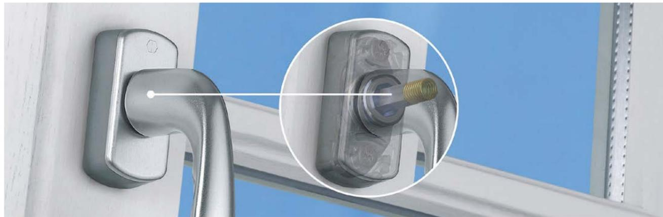
Оконная ручка **Hamburg SecuForte®** регулирует длину штифта в соответствии с заданной глубиной оконного профиля. Это возможно благодаря нажимной пружине, расположенной в середине ручки на штифте. Благодаря пружинному механизму штифт постоянно вдавливается, обеспечивая правильную посадку.
